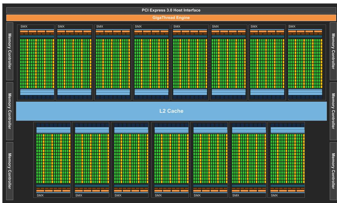
FIG. 2.4 – Répartition des unités de calcul dans les multiprocesseurs de flux (SMX) d'un GPU de type GK110
